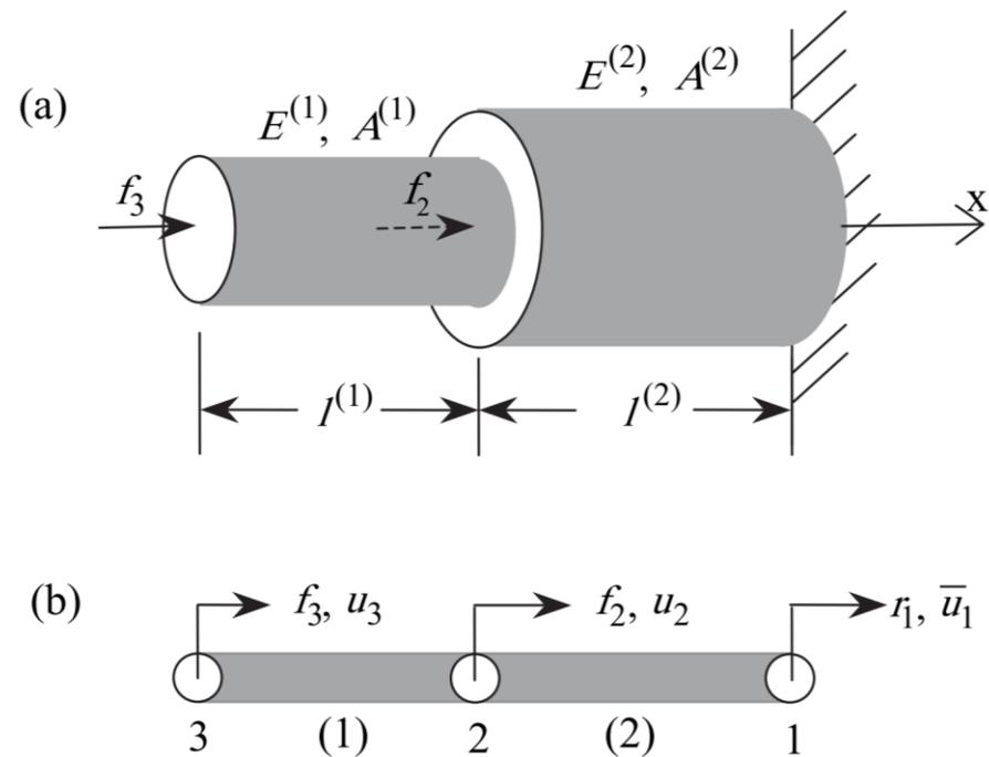
$$\mathbf{F}^e = \mathbf{K}^e \mathbf{d}^e \quad \text{or} \quad \begin{bmatrix} F_1^e \\ F_2^e \end{bmatrix} = \begin{bmatrix} k^e & -k^e \\ -k^e & k^e \end{bmatrix} \begin{bmatrix} u_1^e \\ u_2^e \end{bmatrix}$$
