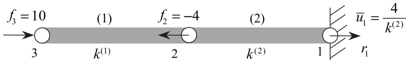
$$\begin{bmatrix} k^{(2)} & -k^{(2)} & 0 \\ -k^{(2)} & k^{(1)} + k^{(2)} & -k^{(1)} \\ 0 & -k^{(1)} & k^{(1)} \end{bmatrix} \begin{bmatrix} \bar{u}_1 \\ u_2 \\ u_3 \end{bmatrix} = \begin{bmatrix} r_1 \\ -4 \\ 10 \end{bmatrix}$$
