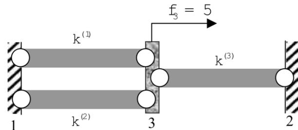
$$\left[ \begin{array}{cc|cc} k^{(1)} + k^{(2)} & 0 & -k^{(1)} - k^{(2)} & 0 \\ 0 & k^{(3)} & -k^{(3)} & 0 \\ \hline -k^{(1)} - k^{(2)} & -k^{(3)} & k^{(1)} + k^{(2)} + k^{(3)} & 5 \end{array} \right] \begin{bmatrix} 0 \\ 0 \\ u_3 \end{bmatrix} = \begin{bmatrix} r_1 \\ r_2 \\ 5 \end{bmatrix}$$
