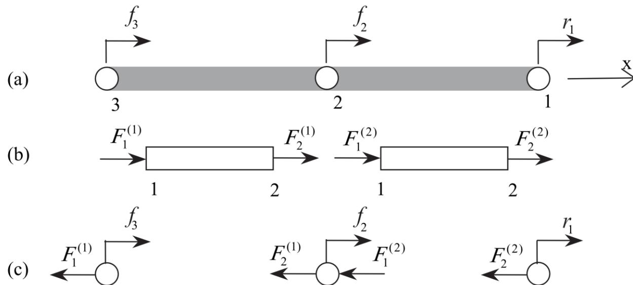
(a)系统; (b)单元的脱离体图 (图中内力为节点对单元的作用); (c)节点脱离体图 (图中内力为单元对节点的作用)。
