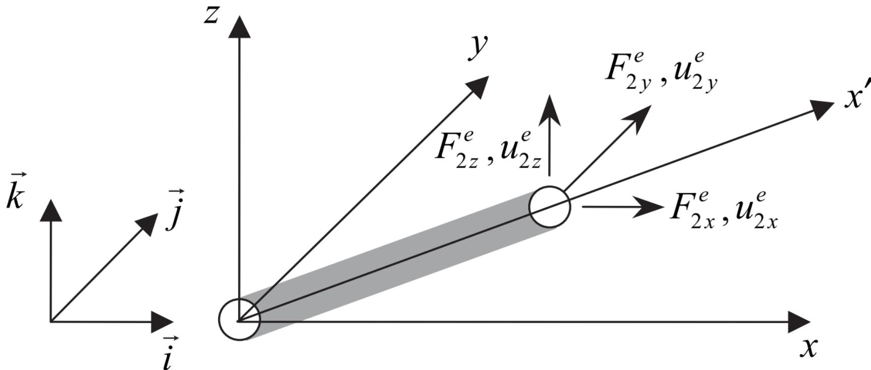
◆ 整体坐标系中的单元自由度向量和节点力向量：
