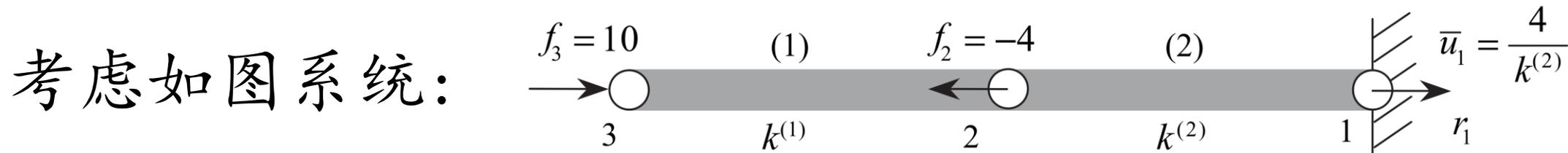
$$\left[ \begin{array}{c|cc} k^{(2)} & -k^{(2)} & 0 \\ \hline -k^{(2)} & k^{(1)} + k^{(2)} & -k^{(1)} \\ 0 & -k^{(1)} & k^{(1)} \end{array} \right] \begin{bmatrix} \bar{u}_1 \\ u_2 \\ u_3 \end{bmatrix} = \begin{bmatrix} r_1 \\ -4 \\ 10 \end{bmatrix}$$
