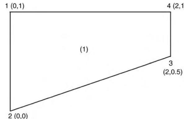
$$10^7 \begin{bmatrix} 2 & -0.82 & -1.18 & 0.25 \\ & 3.82 & 0.33 & -3.53 \\ & & 1.59 & 0.25 \\ \text{SYM} & & & 3.67 \end{bmatrix} \begin{bmatrix} u_{x3} \\ u_{y3} \\ u_{x4} \\ u_{y4} \end{bmatrix} = \begin{bmatrix} 0 \\ 0 \\ 0 \\ -20 \end{bmatrix}$$
