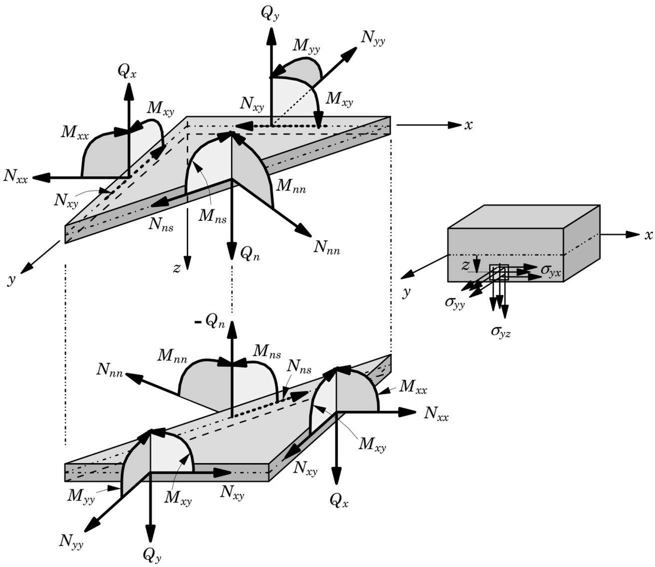
在斜面上， $N_{nn}$ 以外法线方向为正； $Q_n$ 以z轴正向为正， $M_{nn}$ 以斜面上z坐标最大处的应力产生的弯矩为正；给定s方向(切向)后， $N_{ns}$ (以及切应力)以切向为正， $M_{ns}$ 以切应力在z最大处产生的弯矩为正向。
