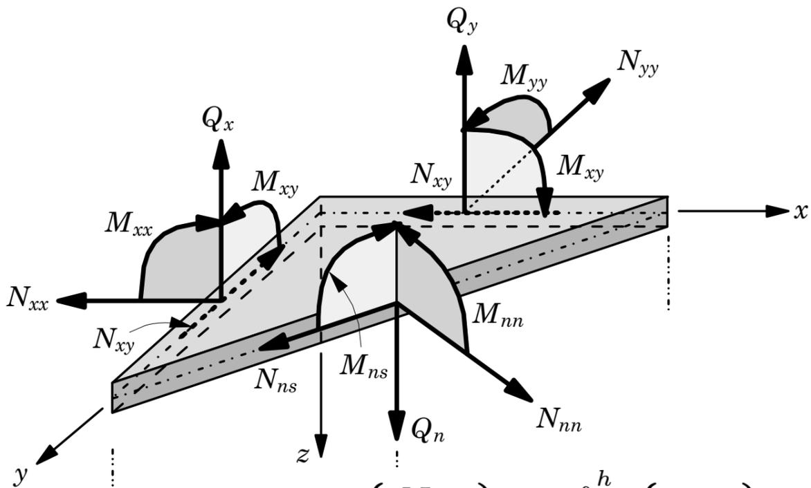
在斜面上， $N_{nn}$ 以外法线方向为正； $Q_n$ 以 $z$ 轴正向为正， $M_{nn}$ 以斜面上 $z$ 坐标最大处的应力产生的弯矩为正；给定 $s$ 方向(切向)后， $N_{ns}$ (以及切应力)以切向为正， $M_{ns}$ 以切应力在 $z$ 最大处产生的弯矩为正向。
